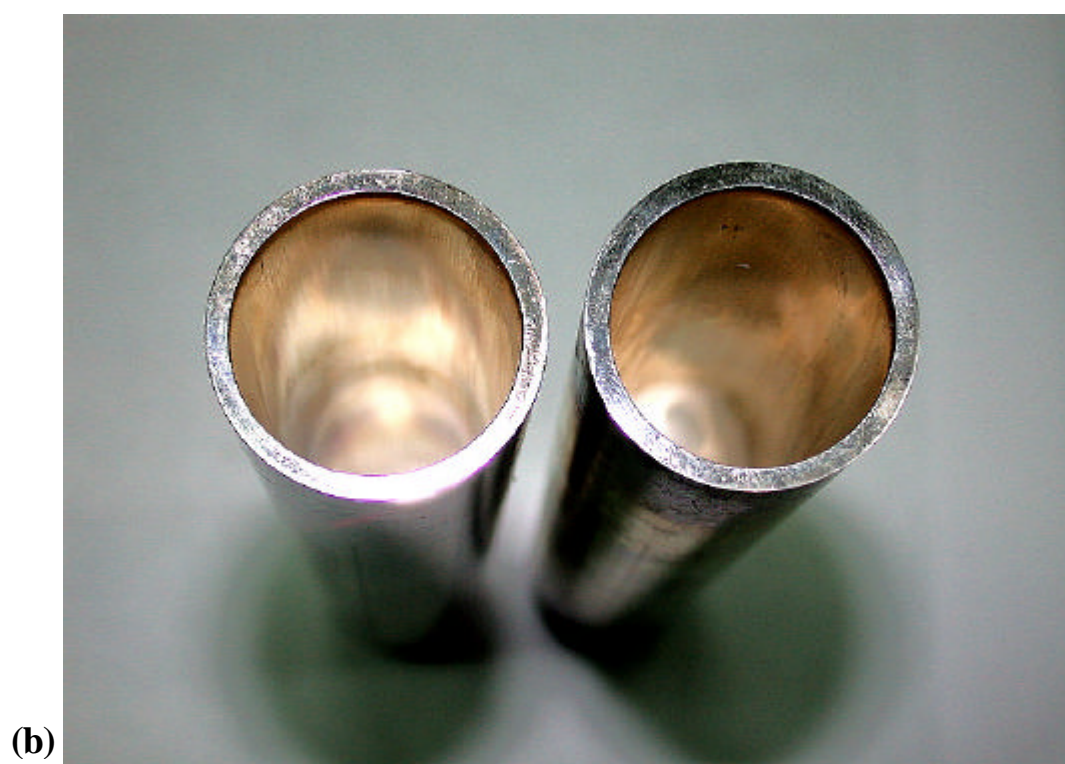
圖 3-36 壁厚 2.5 mm 的內徑研磨後之實體照片 (a) 平放 (b) 直立
