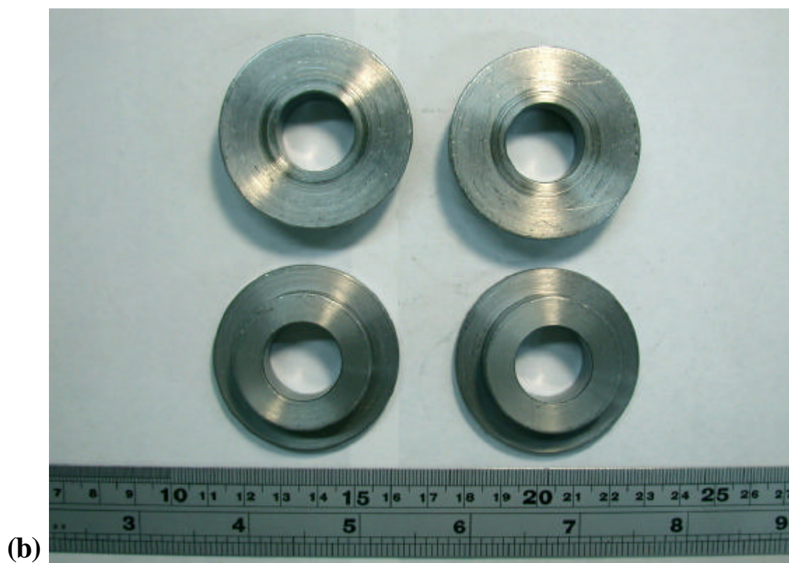
圖 2-25 自行設計的連結上、下封蓋板與上、下進油管墊圈 (a) 尺寸示意圖 (b) 實體照片
