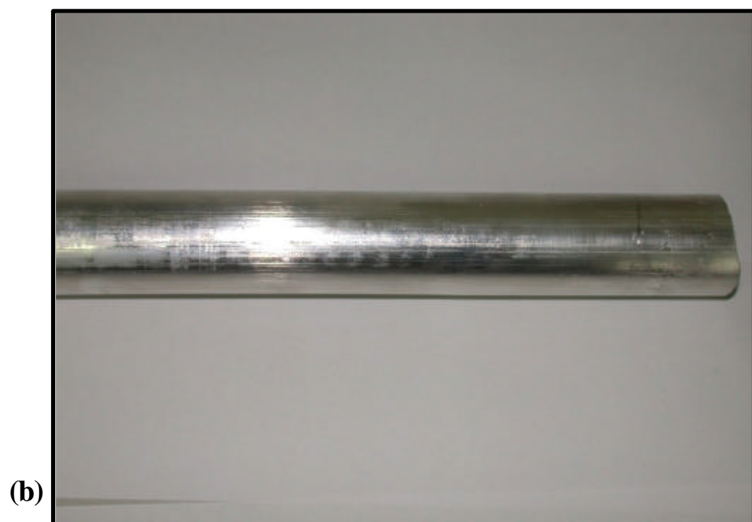
圖 3-3 擠型後管子的照片 (a) 前段氧化粗糙 (b) 中、後段表面光亮
