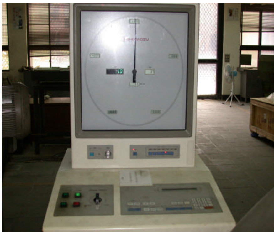
圖 3-44 以 SHIMADZU UH-1000kNA 萬能試驗機壓平 (a) 即將壓平狀態 (b) 控制機台
