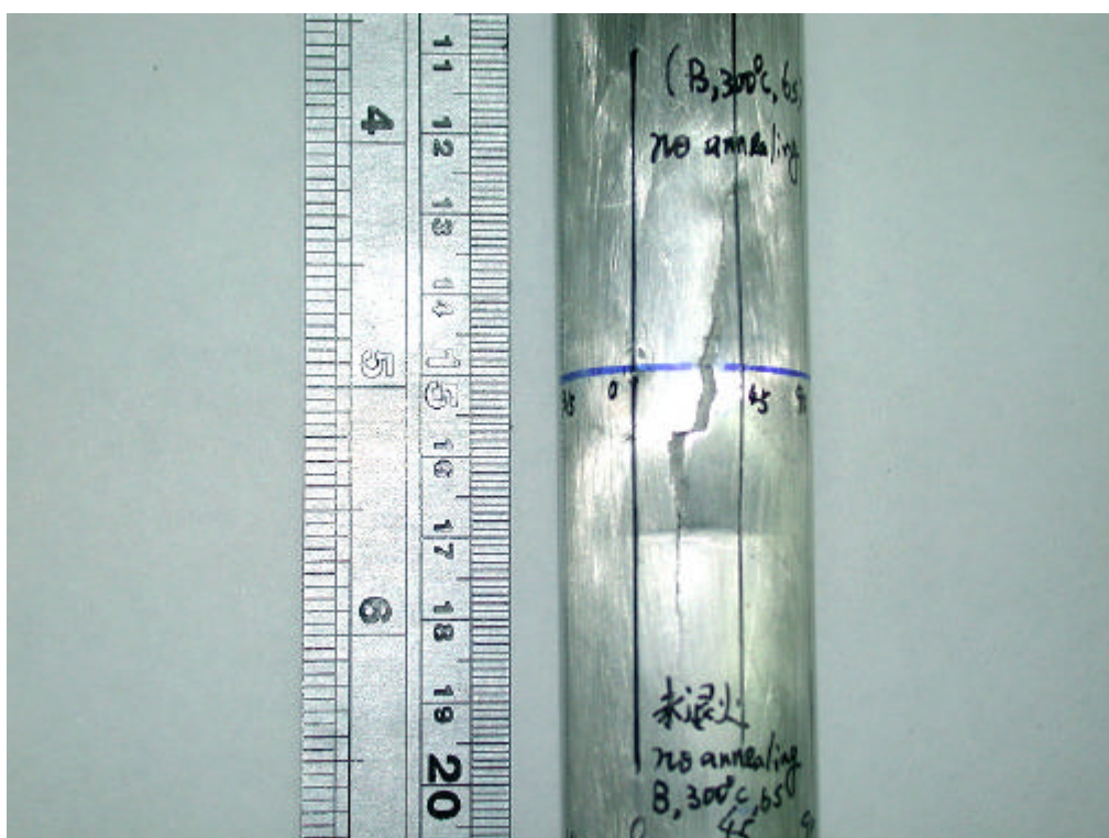
圖 3-37 未退火管材室溫鼓脹破裂照片 (a) 編號 4 , 250 °C、 1.1 \times 10^0 \text{ s}^{-1} 擠製的管材 (b) 編號 8、300 °C、 1.1 \times 10^0 \text{ s}^{-1} 擠製的管材
