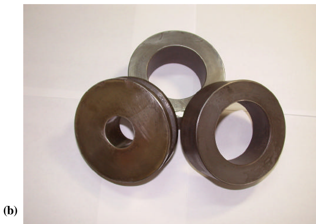
圖 2-8 管材出口成形的模具組(a) 尺寸示意圖 (b) 實體照片
