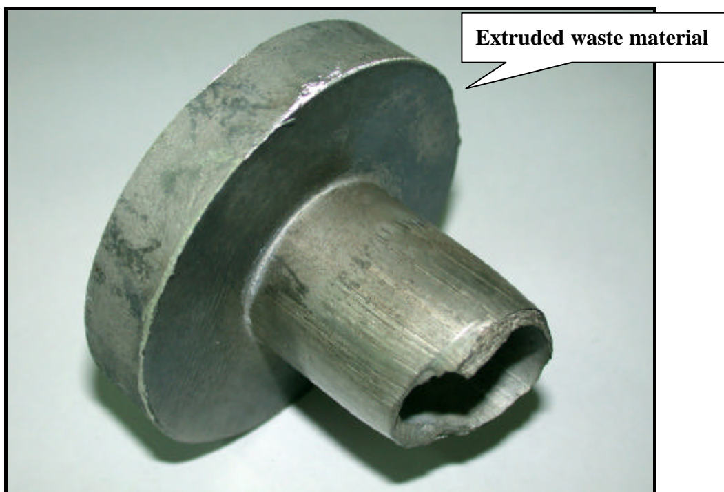
圖 3-4 擠型成形後的 AZ31 無縫管被剪斷設備的照片 (a) 斷面壓凹破裂的局部照片 (b) 浪費成品約 40~50 mm
