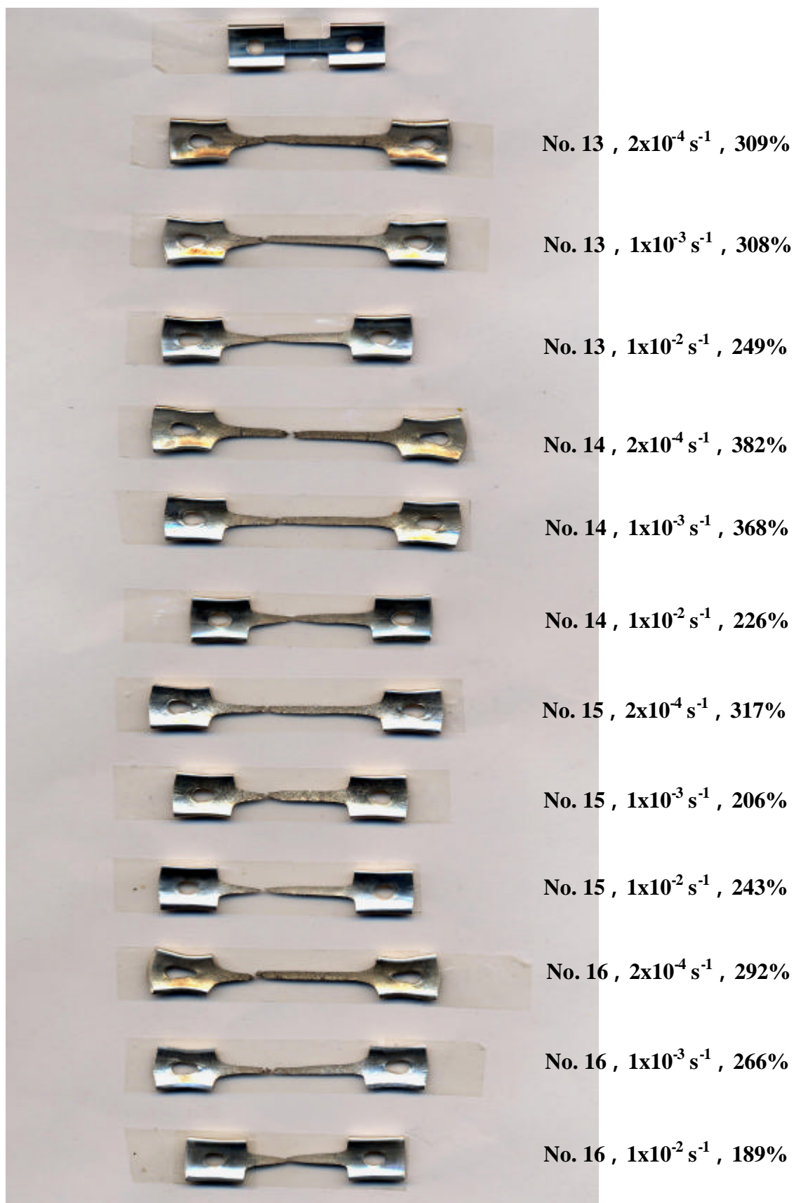
圖 3-32 高溫 400 °C 擠製試片經高溫 400 °C 拉伸測試後的外貌圖片
